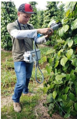
Figura 1. Análise de trocas gasosas com uso do IRGA
