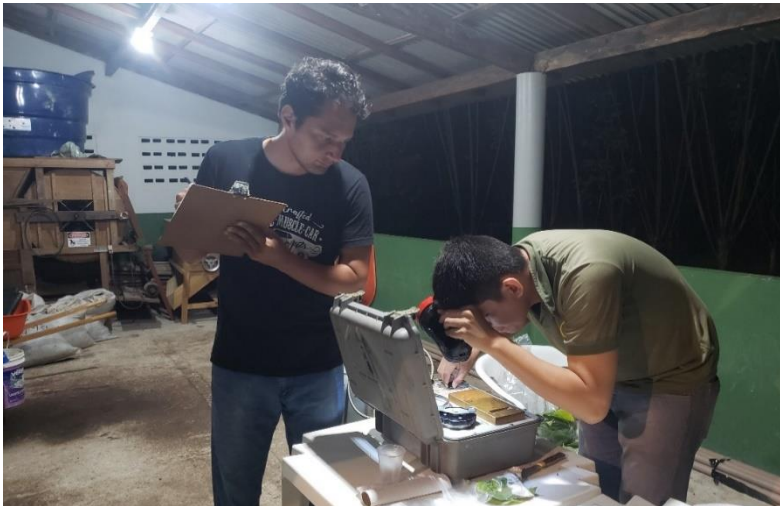
Figura 2. Avaliação do potencial hídrico com uso da bomba de Scholander
