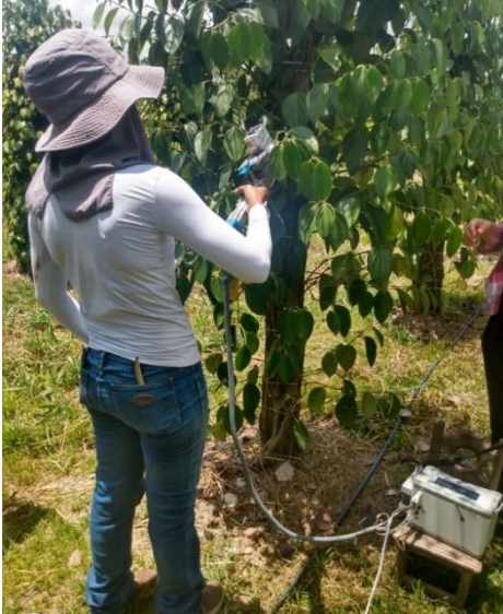
Figura 16. Análise de trocas gasosas com uso do IRGA
