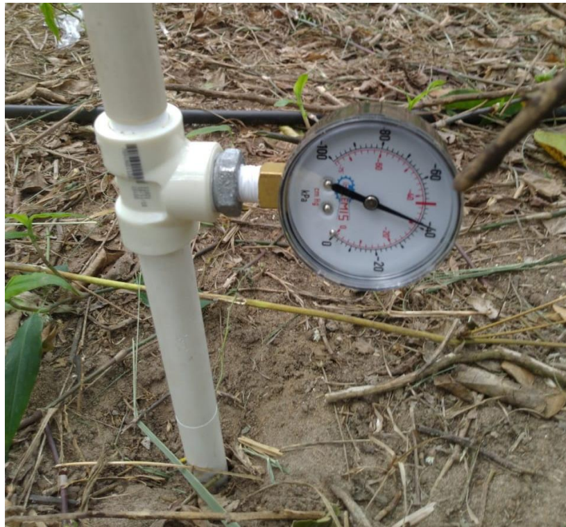
Figura I.1 — Um dos tensiômetros instalados no experimento, mostrando uma leitura de tensão de aproximadamente 40 kPa em novembro de 2020.
