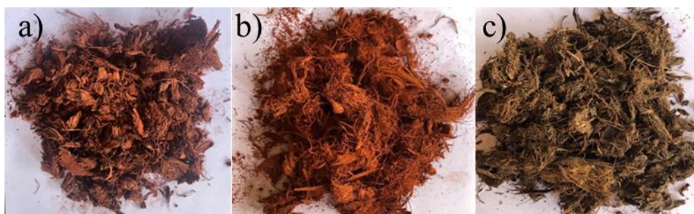
Figura 1. Aspecto dos condicionadores antes da aplicação nas colunas de lixiviação com solo. a) T1: 25% RB + 75% POC (resíduos de palma de óleo decomposto); b) T2: 50% RB + 50% POMW (resíduos de palma de óleo); c) T3: 100% POMW (resíduos de palma de óleo sem RB).
