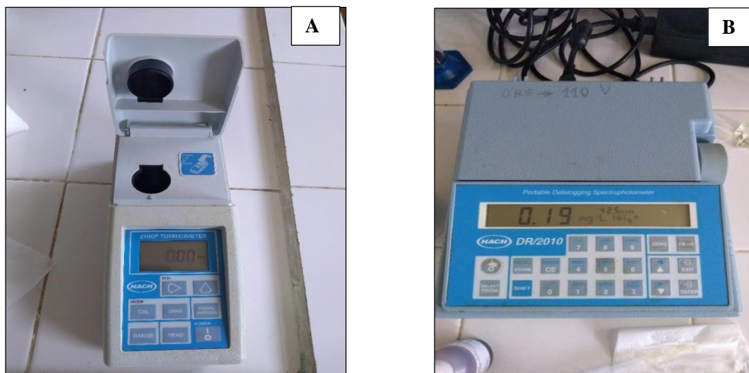
Figura 4. Sondas utilizados no laboratório: a) 2100P TURBIDIMETER; b) Portable Datalogging Spectrophotometer – DR/2010.
