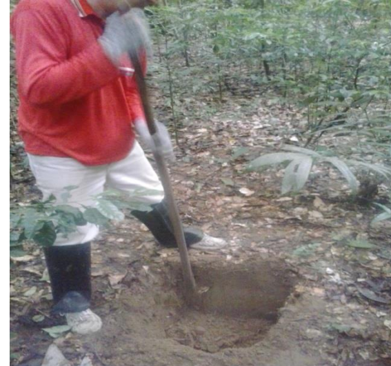
Figura 2A: Abertura de Trincheira para coleta de amostras indeformadas (agregados) na Parcela A do experimento ESECAFLOR, Caxiuanã-PA.
