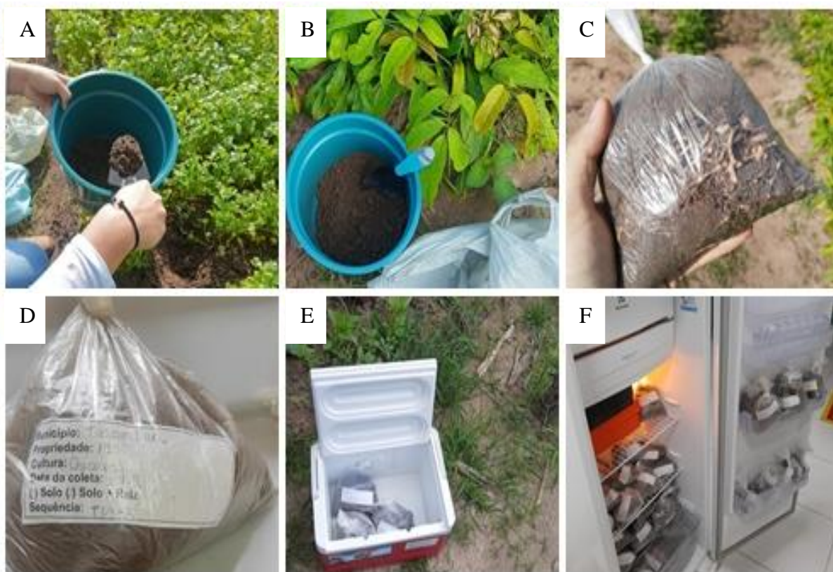
Figura 4 - Homogeneização das subamostras (A). Amostra homogeneizadas (B). Amostra composta com 500 g de solo e 200 g de raízes e acondicionadas em sacos plásticos (C). Amostra identificadas (D). Amostras conservadas em caixa térmica (E). Amostras acondicionadas em geladeira a 10° (F).
