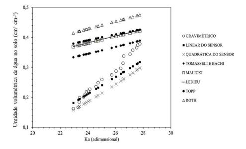
FIGURA V. Comportamento da umidade volumétrica de água no solo (θ) entre 0,16 a 0,38 cm³ cm⁻³ dos modelos de calibração da literatura e da CSI pela relação entre a θ em função da constante dielétrica aparente do solo (Ka) para Latossolo Amarelo Distrófico.
