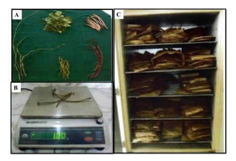
Figura 6. Biomassa do feijão-caupi coleta e separada (A) para pesagem na balança de precisão (B) levados a estufa numa temperatura média de 70 °C (C).
