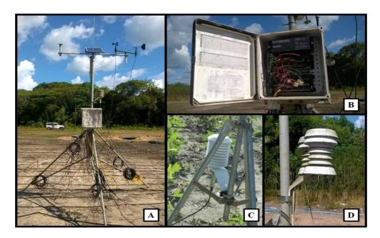
Figura 5. Torre micrometeorológica (A), estação meteorológica automática (B), sensor de temperatura e umidade relativa do ar a 0,5 m (C) e 2 m (D) acima do dossel.
