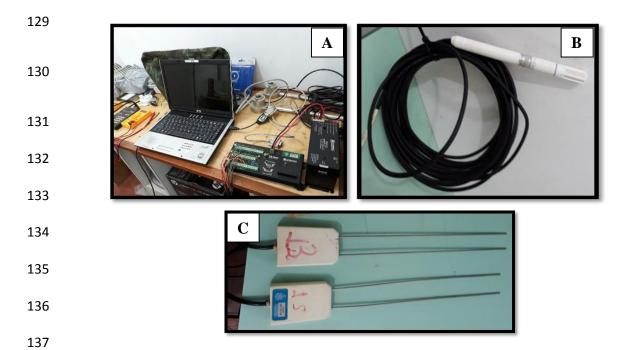
FIGURA II. Computador, *data logger*, bateria (A), sensor de temperatura e umidade do ar (B), sensores CS616 (C) utilizados na medição da umidade volumétrica de água no latossolo amarelo distrófico.
