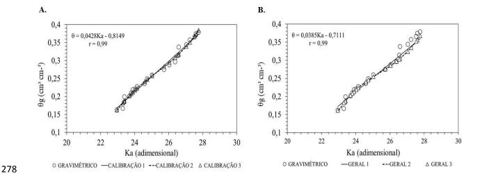
FIGURA IV. Comportamento do conteúdo de água no solo estimada pelos três melhores modelos de calibração obtidos com amostras individuais (A) e com todos os pontos das quatros amostras de solo (B) do experimento de calibração dos sensores CS616, 2018.
