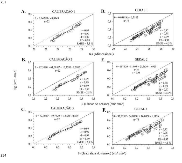
FIGURA III. Calibrações entre a θg em função da Ka (IIIA, IIID), θg e equação linear do sensor (IIIB, IIIE), θg e equação quadrática do sensor (IIIC, IIIF). Avaliação dos modelos pelo
