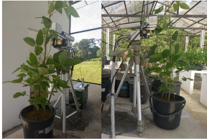
Figura 8: Plantas de soja em estágio reprodutivo (R2), realização da leitura com o equipamento infra red gas analyser – IRGA.
