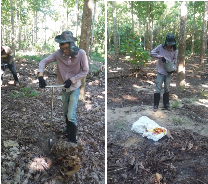
Figura 7 - Amostragem e homogeneização de amostras de solo.
