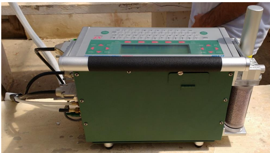
Ilustração 4. IRGA-Analisador de trocas gasosas por infravermelho.
